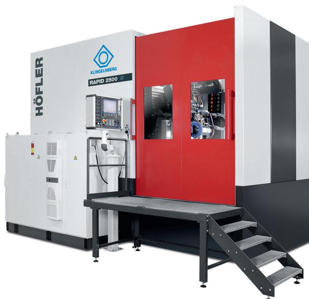
2 Auf einer Verzahnungsschleifmaschine 'Klingelberg Höfler Rapid 2500' ergab die Optimierung mit dem Schleifwerkzeug 'Blue Moon TZ' von Krebs & Riedel einen kühleren Schliff und eine längere Standzeit bei bis zu 20 Prozent kürzerer Schleifzeit im Vergleich zu Standard-scheiben © Klingelberg
